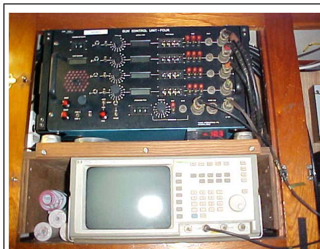
Fig. 9.3 Monitor con el cual se lleva el control del cañon de aire
