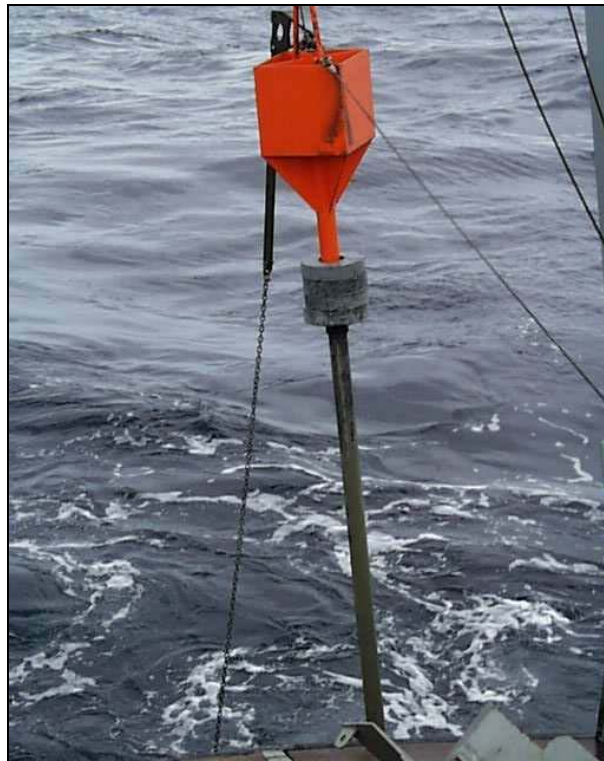
Fig. 9.7 Muestreador utilizado en el levantamiento Fugro-2001, con un peso aproximado de 300 kg
