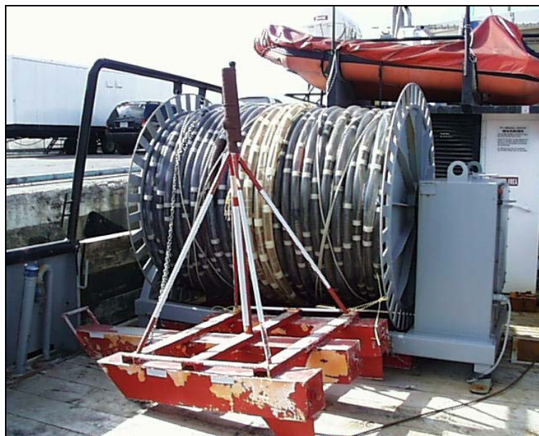
Fig. 9.5 Cable del streamer utilizado en el levantamiento Fugro-2001
