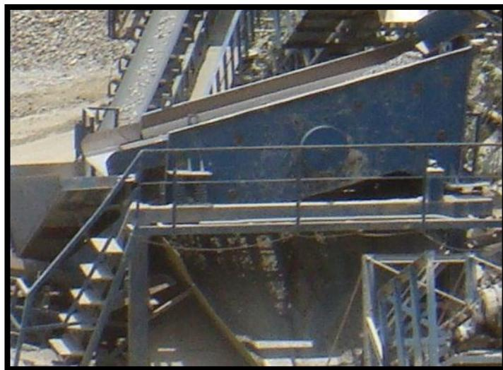
Ilustración 13. Criba clasificadora. Fuente propia 09/08/2013.
