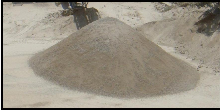
Ilustración 14. Material producido, arena lavada. Fuente propia 09/08/2013.
