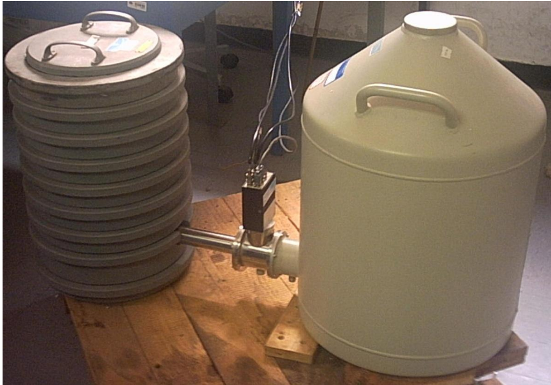
Figura 5 Espectrómetro de radiación gamma, detector semiconductor de germanio hiperpuro (HPGe). (Tomado de Barros, 2016)
