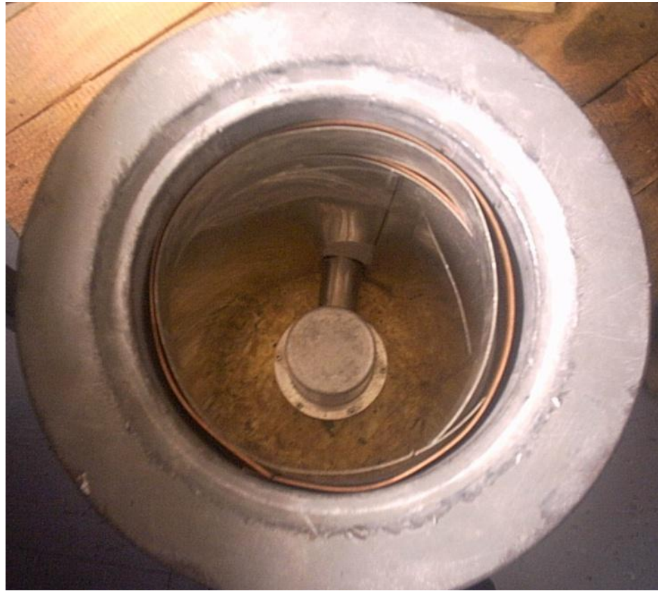
Figura 6 Interior del blindaje de plomo para disminuir el nivel fondo de radiactividad ambiental y carcasa de aluminio del detector HPGe. (Tomado de Barros, 2016)
