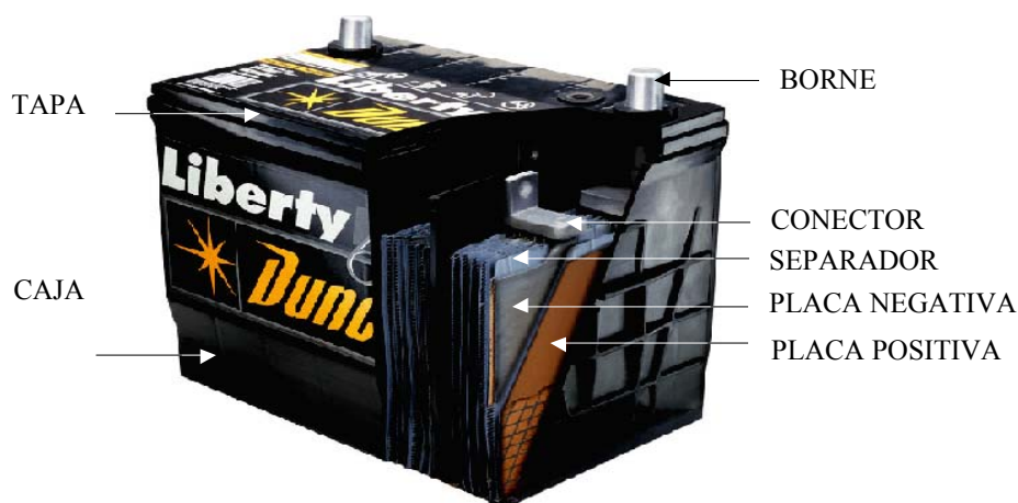
Figura N° 3. Elementos principales de una Batería de Plomo Ácido (Fuente: Acumuladores Titán)
