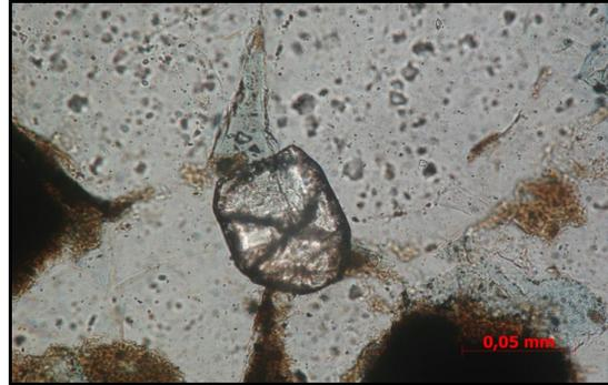
Figura 65. Fotomicrografía con fragmento de circón. Ocular 40X. Nícoles paralelos. Profundidad 9495' del núcleo VLC1184.
