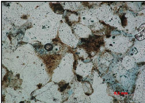
Figura 78. Fotomicrografía mostrando disolución de minerales de arcilla. Ocular 10X. Nicoles paralelos. Profundidad 9684' del núcleo VLC1184.
