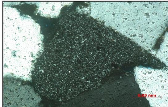
Figura 63. Fotomicrografía en donde se observa otro fragmento de chert. Ocular 40X. Nícoles cruzados. Profundidad 9528' del núcleo VLC1184.
