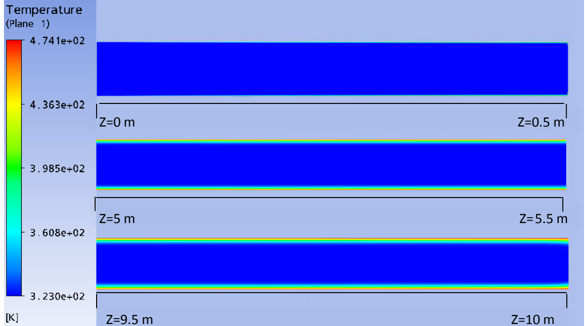
Figura 93. Perfil de temperatura para cilindro cuando se tiene una longitud axial adimensional elevada a la \frac{1}{2} de 0.02 a viscosidad variable con B=5 .
