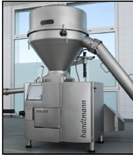
**Figura N° 16.** Embutidora al vacío para productos de músculo entero
