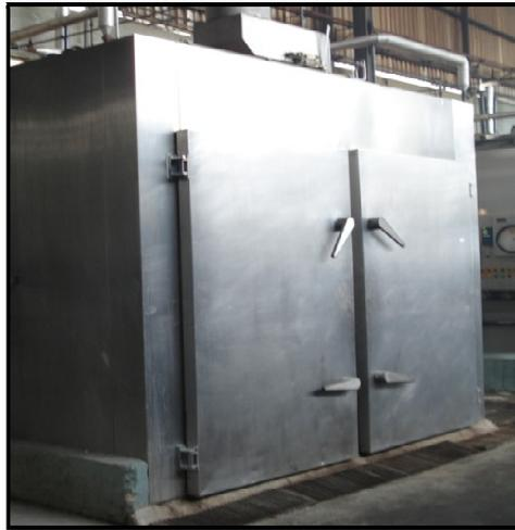
**Figura N° 17.** Horno para cocción de embutidos
