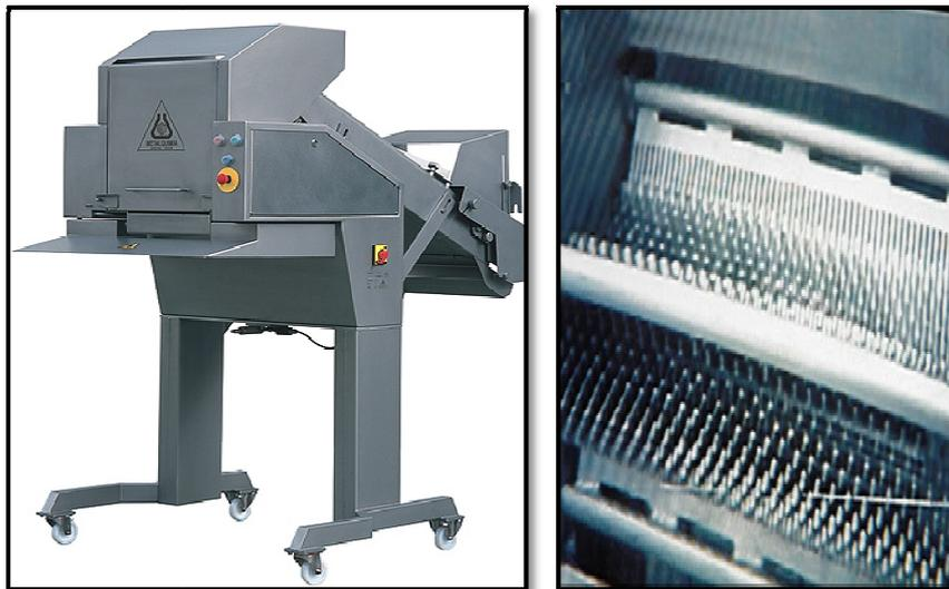
**Figura Nº 13.** Tenderizadora con ablandadores cilíndricos de cuchilla (Xargayó, 2007)
