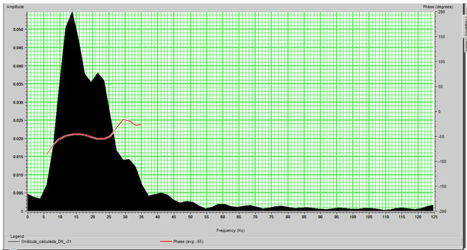
Figura 5.3. Espectro de amplitud del cubo sísmico original y sin aplicación de filtros estructurales
