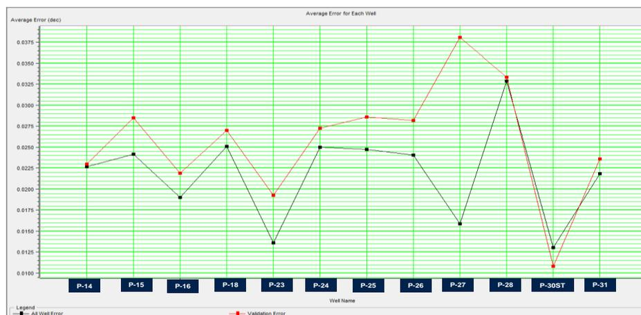
Figura 5.33. Gráfico de error de validación (en rojo) y predicción (en negro). Nótese como solo el pozo P-27, obtuvo una diferencia entre los dos errores 1,5 %.
