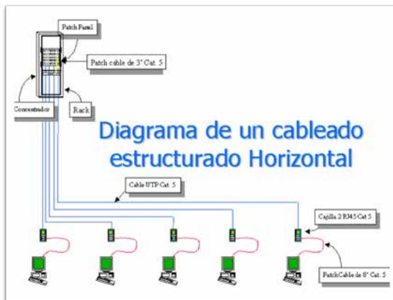
**Figura 7** Diagrama del SCS Horizontal
