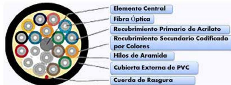
**Figura 9** Elementos de la Fibra Óptica
