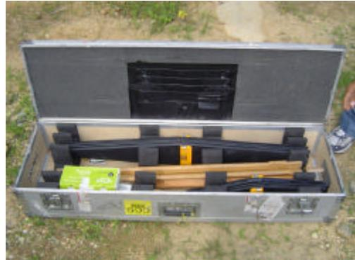
Fig. N° 3.5: Aparato de adquisición de Radar de Penetración del Subsuelo (GPR) (izquierda), antenas de adquisición de 50, 100 y 200 Mhz (derecha).
