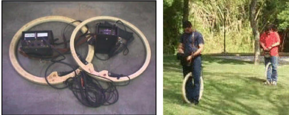
Fig. N° 2.17: Equipo de electromagnético EM-34. Bobinas transmisoras y receptoras (izquierda) y modo de empleo del equipo EM34 usado en campo en la zona de Villa de Cura (derecha). ([www.trxconsulting.com](http://www.trxconsulting.com)).
