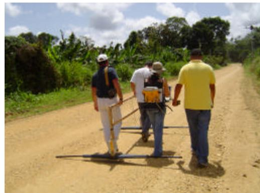
Fig. N° 3.8: Adquisición de datos de Radar de Penetración de subsuelo (GPR) en la zona de Barlovento.
