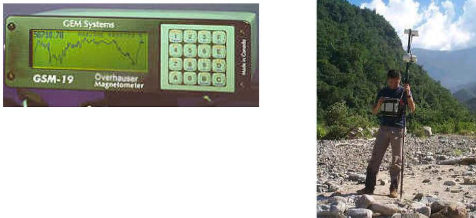
Fig. N°2.18: Modelo GSM-19 usado en campo (izquierda) y modo de adquisición de datos en campo (derecha). (Tomado de trxconsulting.com).
