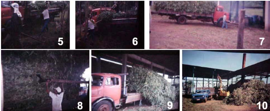
Figura N° 11. Proceso de carga, transporte y descarga de las ramas a escala industrial por el método tradicional (Silveira,2003)
