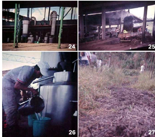
Figura N° 14. Planta de destilación de aceite, proceso de limpieza del extractor, recolección del aceite y zona de cultivo con material exhausto (Silveira, 2003)
