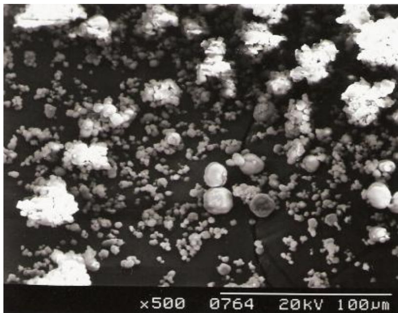
Figura N° 53. Microscopia electrónica de barrido de la zeolita Na-ZSM5 de relación Si/Al = 22 sintetizada con agente orientador y por calentamiento hidrotérmico, la magnificación es 50000.
