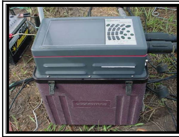
Figura 4.3. Cámara de Refracción Strata Visor NZ11 usada en el proyecto La Florida-Amarilis 04G-3D (Tomado de Pardo J 2005).
