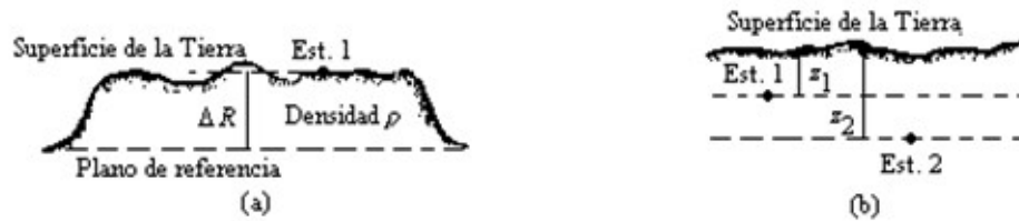
Figura 3.4. Corrección de Bouguer. (a) Estación sobre una meseta extensa. (b) Estaciones subterráneas
