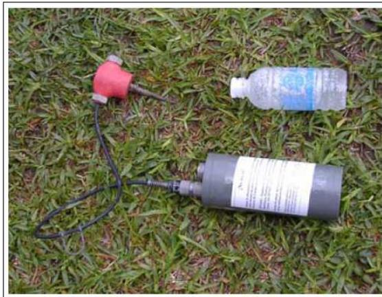
**Figura A-3.** Grabador sísmico independiente autónomo REFTEK modelo 125-A conocido como "Texan". Nótese el geófono de color rojo conectado (tomado de Sánchez, 2004).
