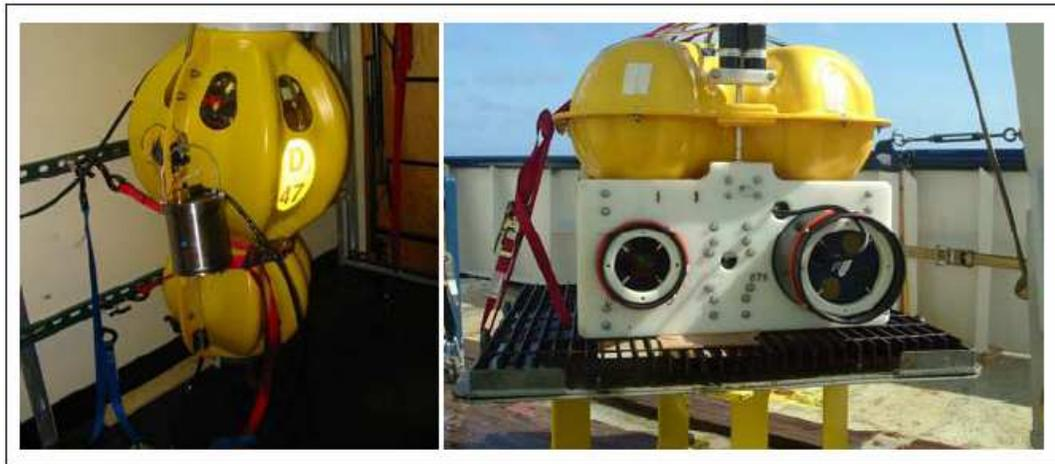
**Figura A-5.** Sismómetros de fondo marino (OBS). Izquierda: Modelo D2 WHOI. Derecha: Modelo LC 2000 (Tomado de Ávila, 2005).
