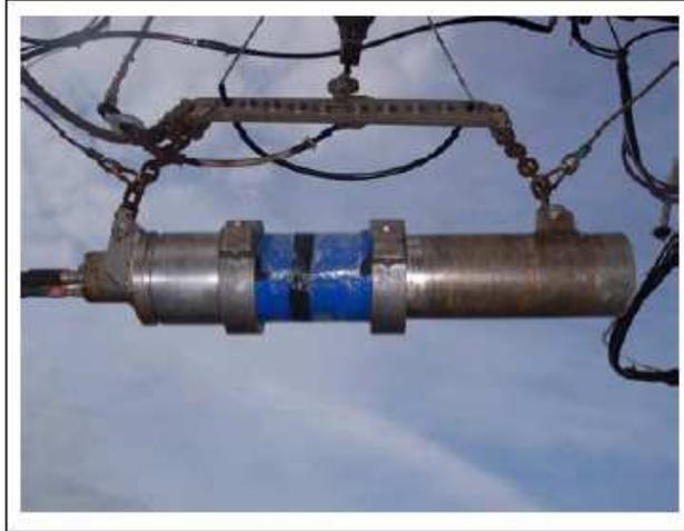
**Figura A-2.** Cañón de aire utilizado como fuente de energía en la adquisición de los perfiles marinos (tomado de Sánchez, 2004).
