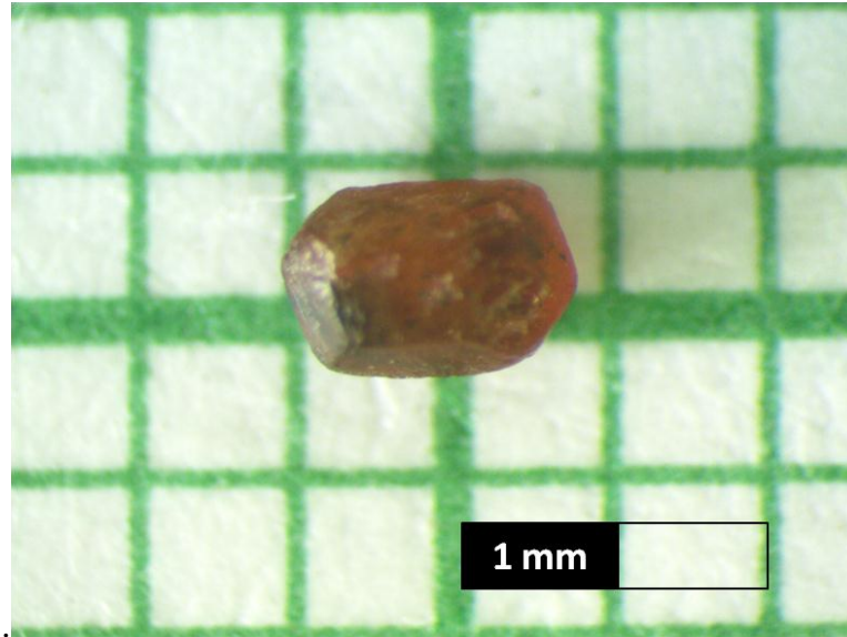
Fig. 81 Rutilo encontrado en la muestra P13S13-Intervalo (-1, 0]
