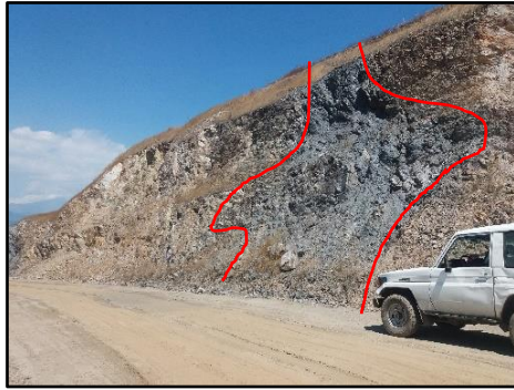
Figura C20 Vista general de talud en cantera visitada. Resaltando en color rojo límites locales de zona grafitosa.
