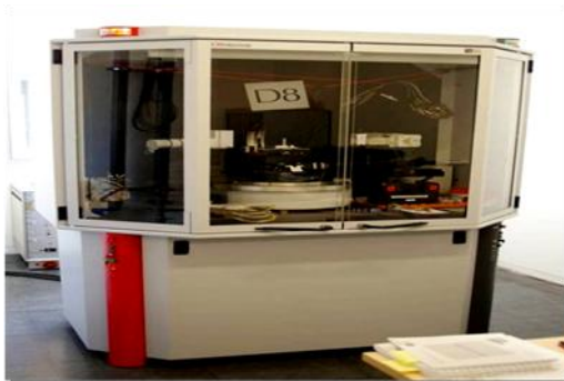
Figura 22. Difractómetro de rayos X marca Bruker axs modelo D-8 Advance.
