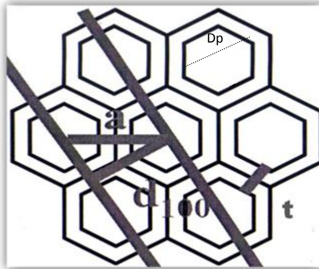
Figura 16. Representación esquemática de una celda hexagonal [33].
