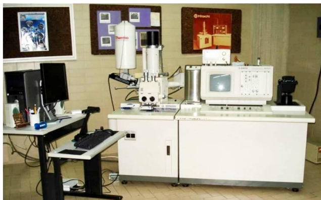
Figura 24. Microscopio electrónico de barrido modelo S-2400.
