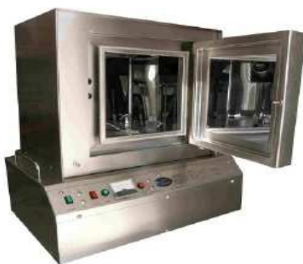
Figura 6: Equipo de Pulsos de Luz modelo XeMaticA 1XL-SA (SteriBeam, Kehl, Alemania). Situado en el Laboratorio de Nuevas Tecnologías y Desarrollo de Productos del Instituto de Ciencia y Tecnología de Alimentos (ICTA) de la Universidad Central de Venezuela
