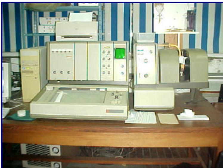
Figura 34 – Espectrómetro de Resonancia Paramagnética Electrónica
