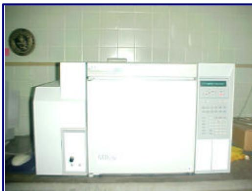
**Figura 39 – Espectrómetro de masa utilizado para el análisis del coque soluble**
