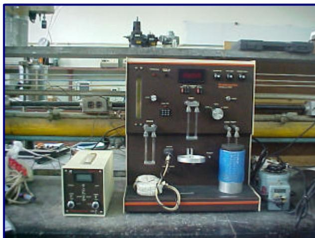
**Figura 29 – Equipo utilizado para la adsorción física de nitrógeno**
