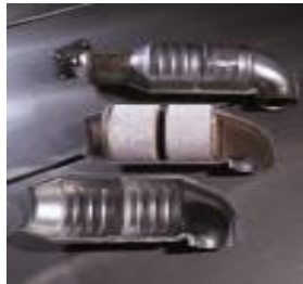
Figura 13. Monolitos cerámicos de Cordierita usados en la fabricación de convertidores catalíticos en el sector automotriz [28] .
