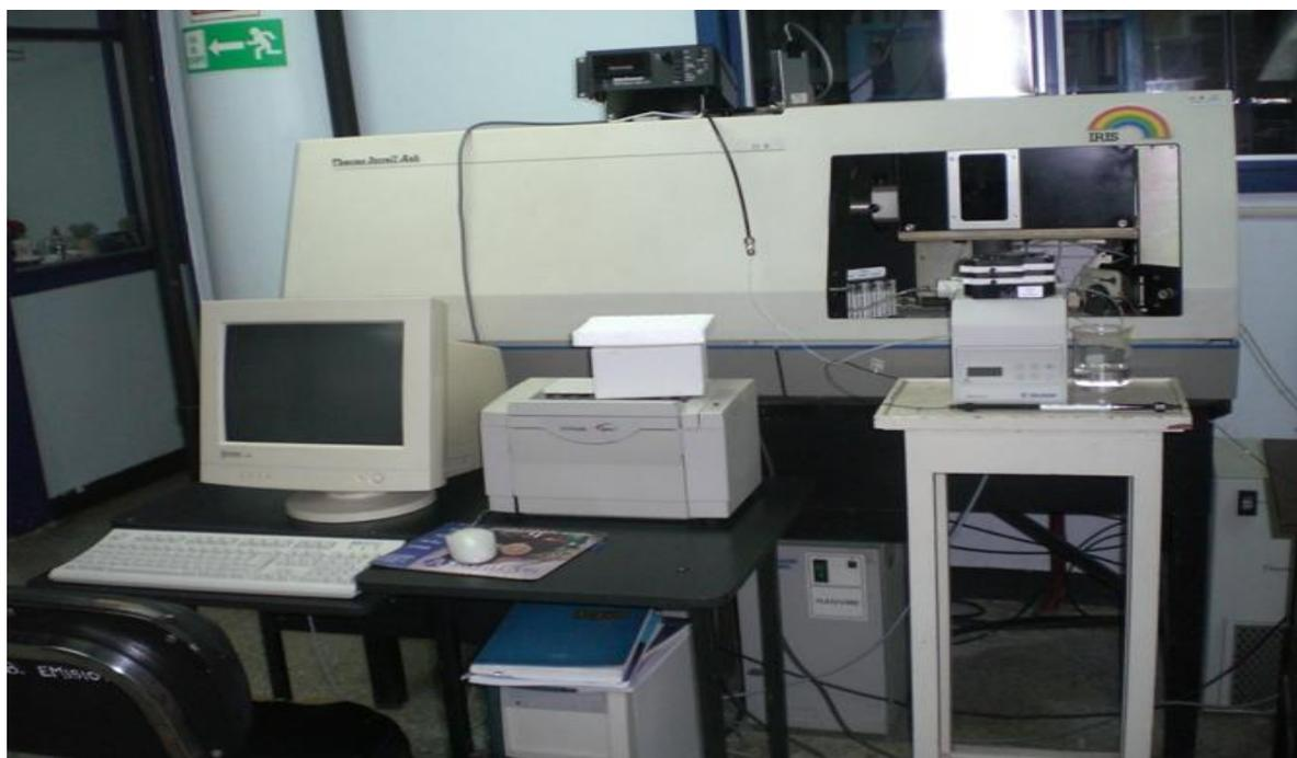
**Figura 10. Espectrómetro de emisión atómica Thermo Jarrell Ash**
