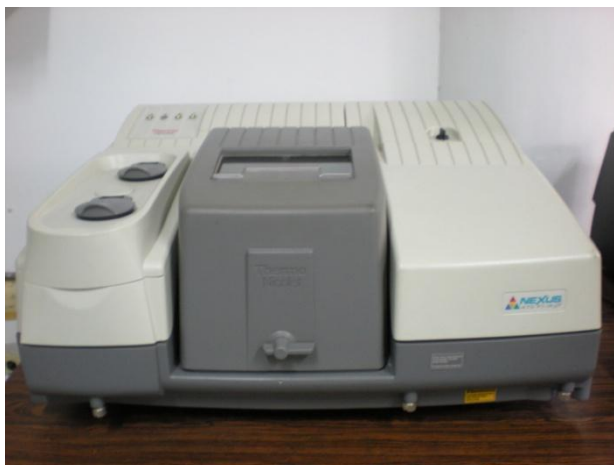
Figura 7: Equipo para análisis de IRFT: Nexus 470 Thermo Nicolet
