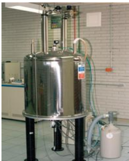
Figura 8: Equipo para análisis de RMN ^1\text{H} y ^{13}\text{C} : JEOL superconducting magnet 270MHz.
