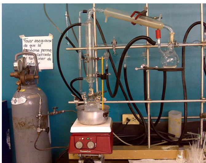
Figura 11: Montaje experimental para secado y destilación de solventes.
