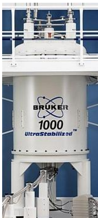
Figura 9: Equipo para análisis de RMN ^1\text{H} y ^{13}\text{C} : BRUKER AVANCE 1000 MHz equipado con 5 mm triple - resonancia.
