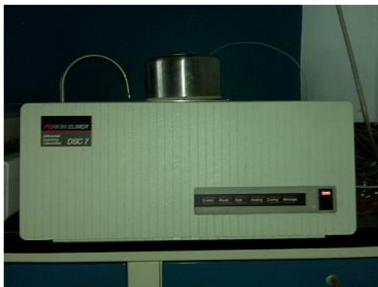
Figura 10: Equipo para análisis de Calorimetría de Barrido Diferencial: Perkin Elmer DSC 7.
