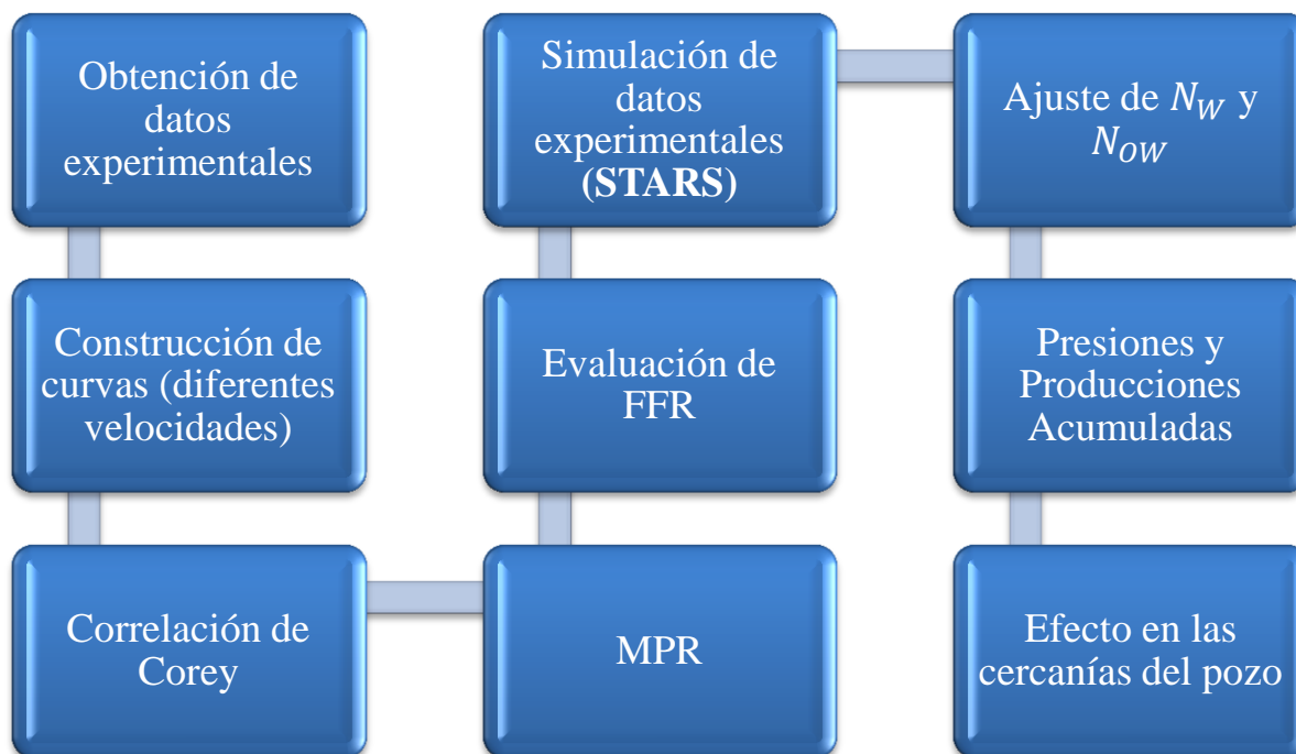
Figura 3.1 Flujo de pruebas de desplazamientos
