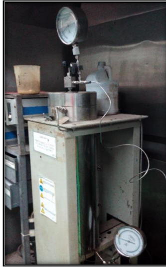
Figura 30. Reactor para recombinado de crudo y gas metano
