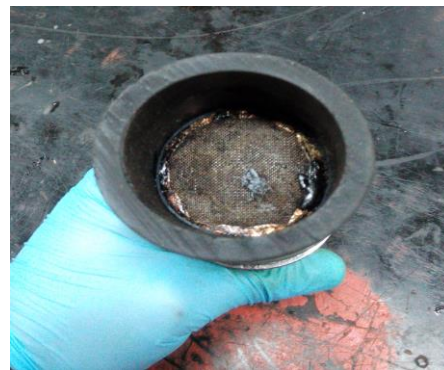
Figura 38. Tapón de núcleo dentro de la manga de neopreno
