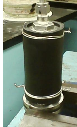
Figura 40. Sistema empacado y ajustado para evitar fugas
