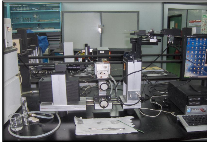
Figura 27. Tensiómetro de gota colgante OCA 20
