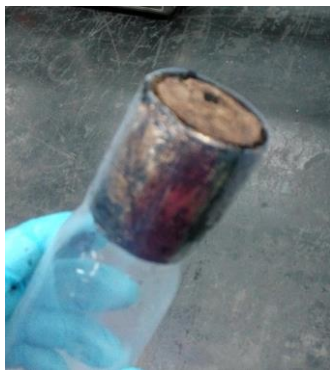
Figura 37. Tapón de núcleo en la manga termo encogible
