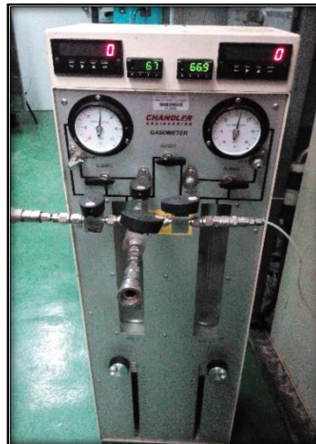
Figura 31. Gasómetro para la cuantificación del gas metano
