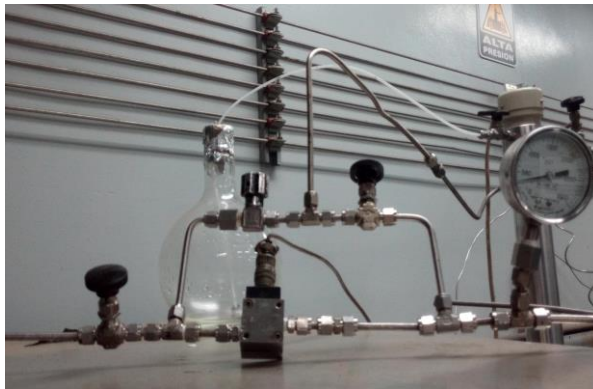
Figura 36. Montaje para la medición del diferencial de presión
