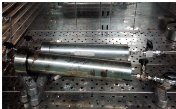
Figura 34. Cilindros tipo pistón con crudo y agua respectivamente
