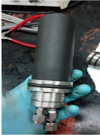
Figura 39. Manga de neopreno ajustada a la empacadura fija de la celda Hassler
