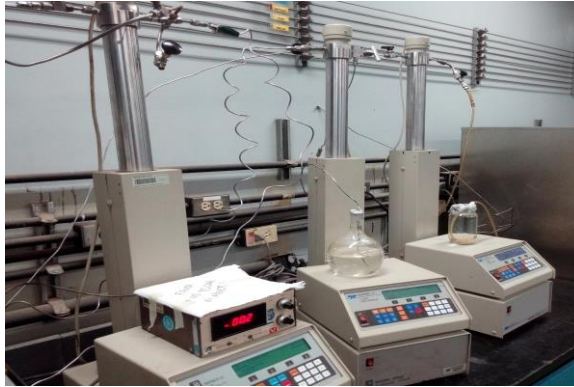
Figura 35. Bombas ISCO, inyección de fluidos (izquierda), presión de sobrecarga (centro), válvula de contra presión (derecha)
