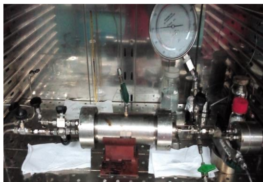
Figura 33. Celda triaxial (centro), válvula de contrapresión (derecha)
