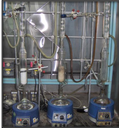
Figura 29. Lavado de arenas en el sistema de extracción Soxhlet
