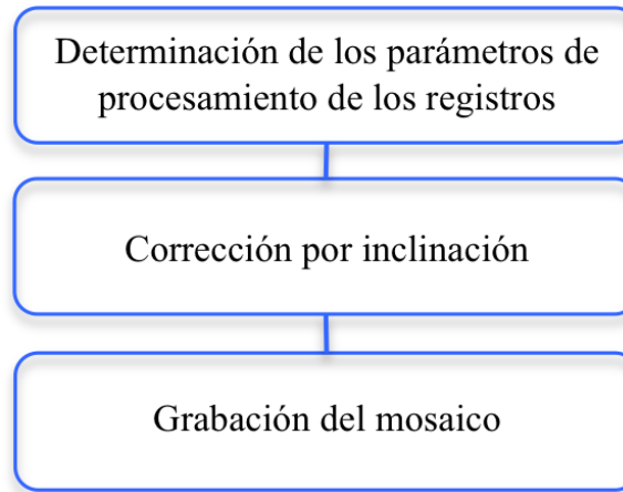
Figura 3.1 Diagrama de procesamiento de los datos de Sonar de Barrido Lateral
