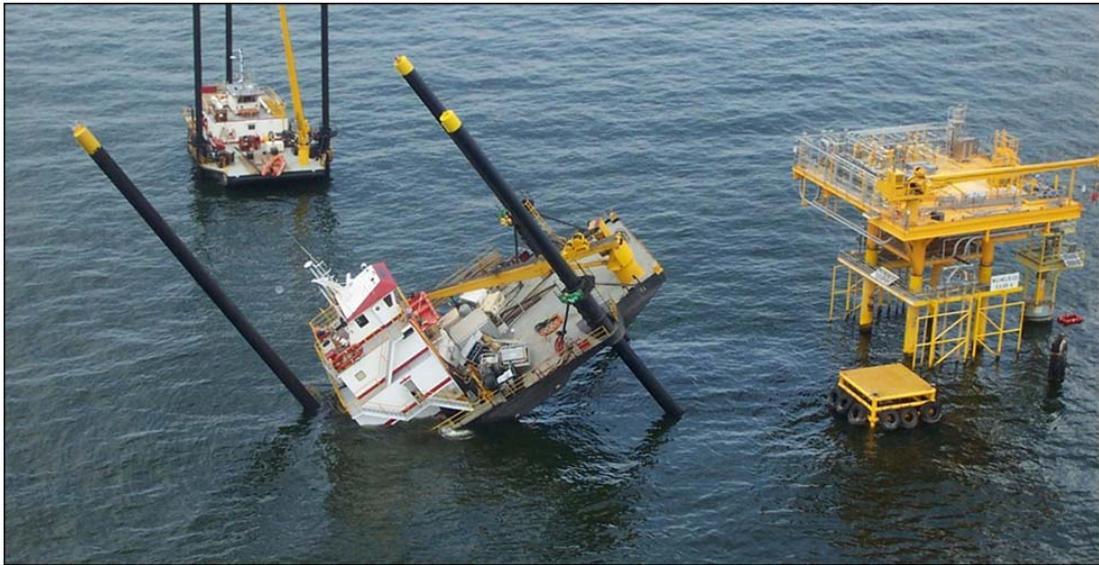
Figura 2.9. Daños generados a una plataforma tipo jack-up como consecuencia del desnivel abrupto causado por una falla por punzonamiento (tomado de Ocean travellers, hydrographyc center, s/f).
