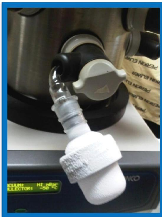
**Fig .17** Proceso de liofilización de la muestra.
