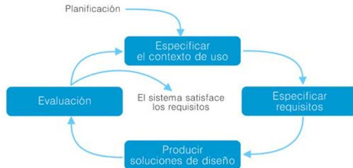
Fig. 1.2. Proceso del Diseño Centrado en el Usuario
