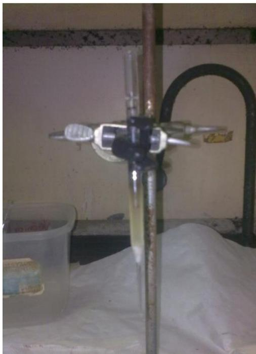
**Figura 26.** Mini columna cromatográfica empacada con gel de sílice en una pipeta Pasteur.
