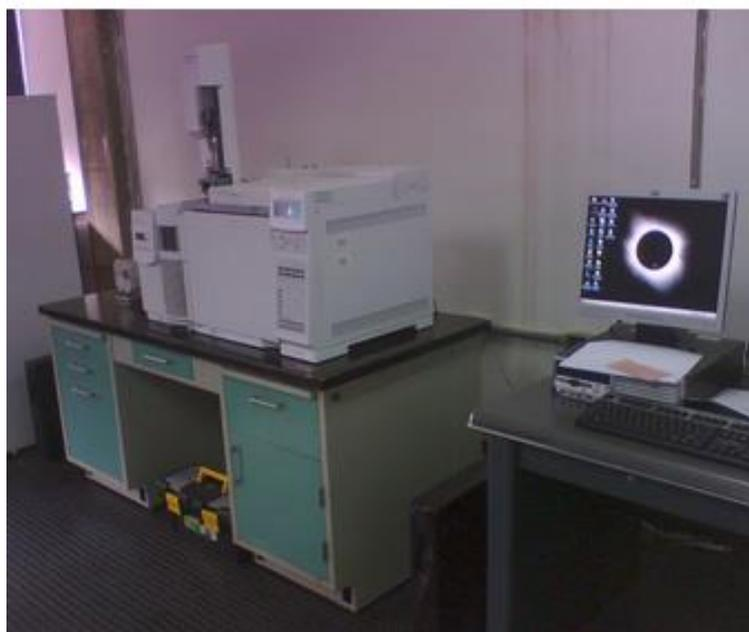
**Figura 28.** Cromatógrafo de Gases modelo 6890N de la Agilent Technologies, con un detector de masas Agilent 5975
