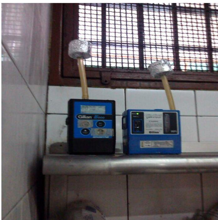
**Figura 35.** Toma de muestras sobre filtros de PTFE, para la cuantificación de los HAP.
