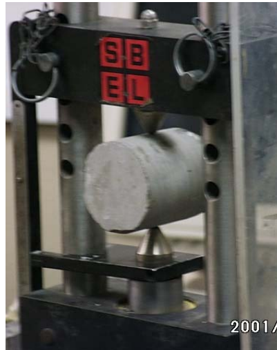
Fig. 18 Ubicación de la muestra en equipo para ensayo de Carga Puntual Diametral
