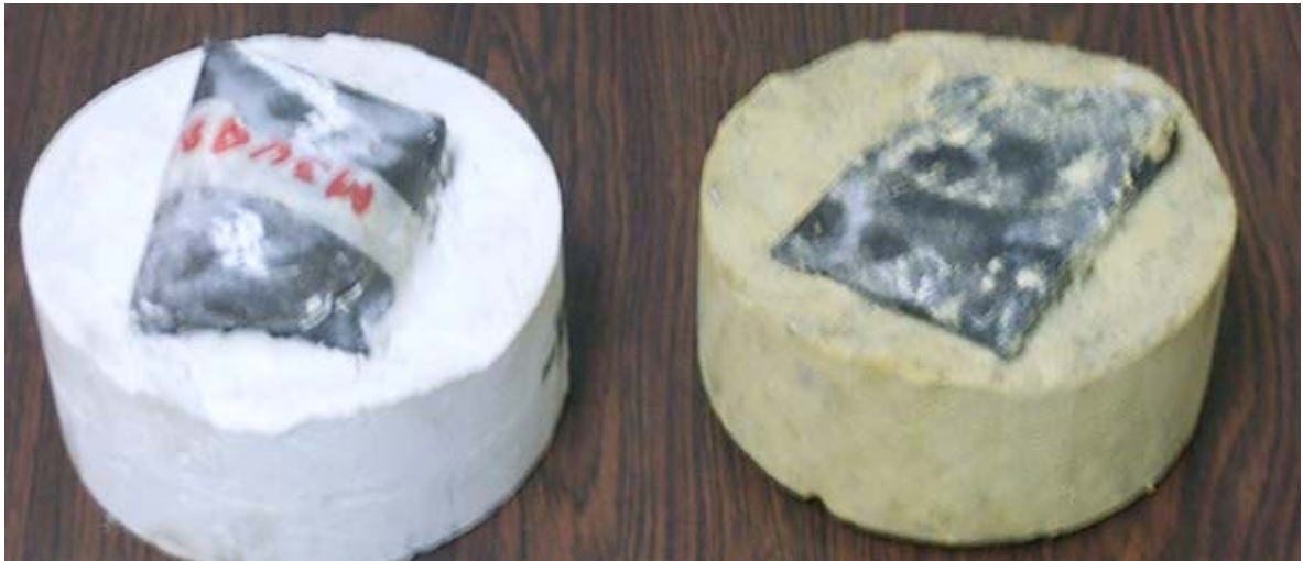
Fig. 31 Montaje de la muestra en el material encapsulante
