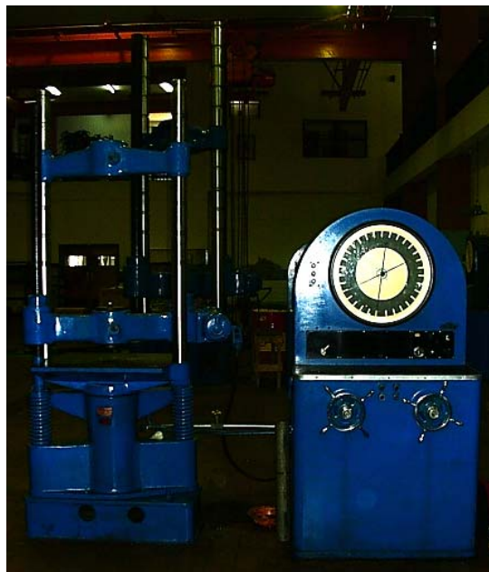
22b Prensa de carga y bomba Electro-hidráulica, marca Baldwin, con capacidad máxima de 100000 Kg. Propiedad del Instituto De Materiales y Modelos Estructurales (IMME), de la Universidad Central de Venezuela
