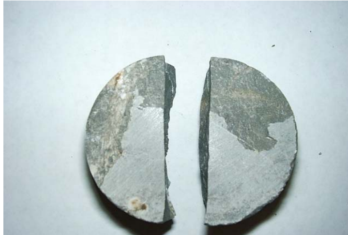
Fig. 27 Fractura Típica de Ensayo de Tracción Indirecta
