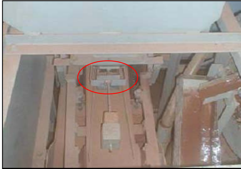
Figura 4. 3 Detalle de la puerta en “v” a la salida del alimentador
