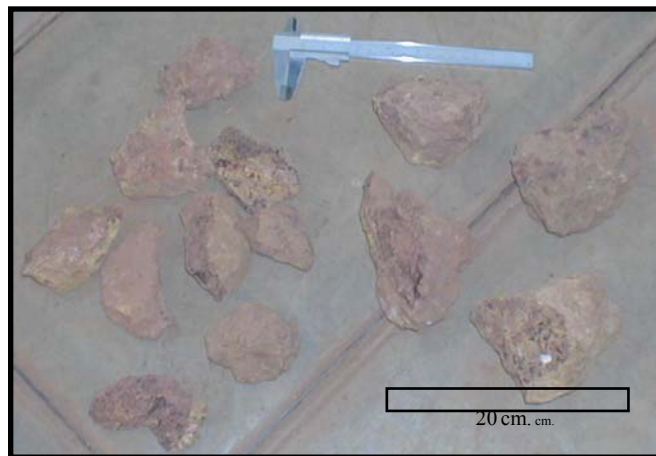
Figura 3. 2 Detalle de los tamaños de trozos iniciales
