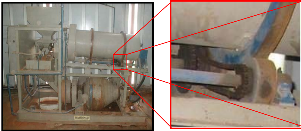
Figura 4. 7 Detalle del mecanismo de rotación del clasificador
