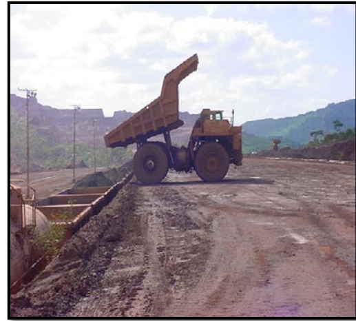
Figura 3.14 Camión cargando vagones.
