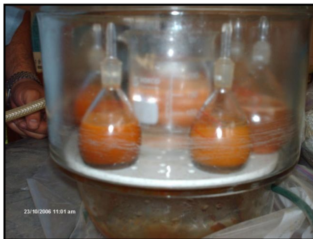
Figura 5.32 Picnómetros con muestras en cámara de vacío.
