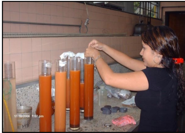
Figura 5.28 Medición con hidrómetro
