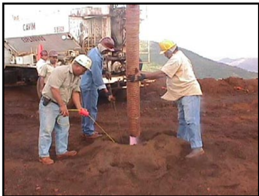
Figura 3.7 Carga de barrenos. Figura 3.8 Vista de una voladura. Fuente: CVG-FMO Jefatura del Área de Planificación y Desarrollo de Mina.
