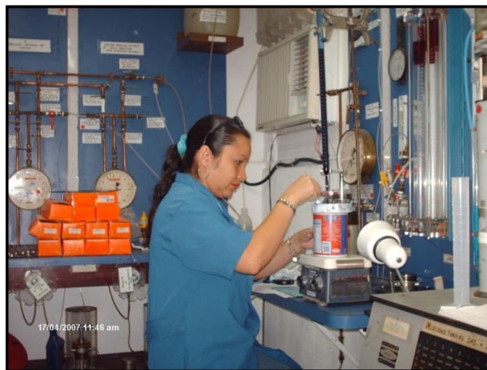
Figura 5.33 Realización de ensayo de azul de metileno.
