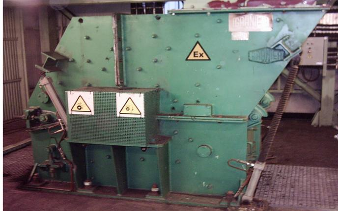
Figura 5: Molino de martillos que comparten la carga
