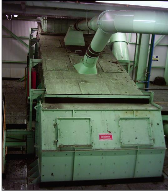
Figura 4 : Se observa la criba vibrante con los captadores de polvo
