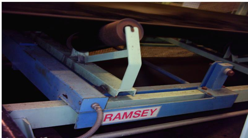
Figura 3: Se observa el rodillo de la báscula Integradora para pesaje
