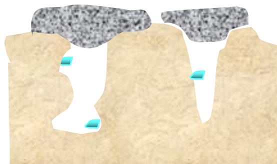
Figura 6. Taponamiento de poros. Debido al pequeño tamaño de los poros de las zeolitas, la entrada de los poros se taponan por la formación de productos no deseados.
