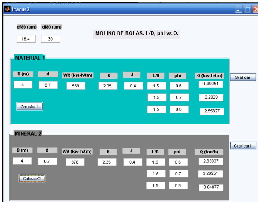
Figura 23: Simulación de phi vs Q. Para L/D=1.5.
