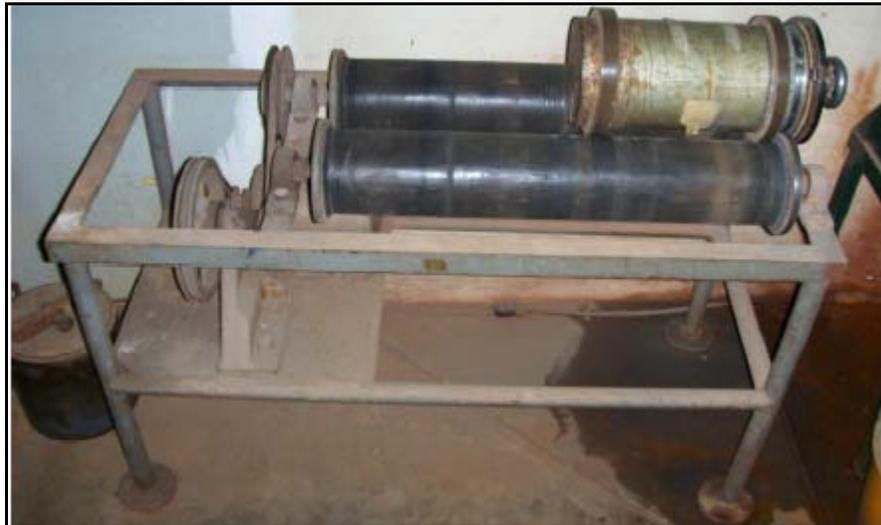
*Figura 8: Molino de barras en bancada de Ghaliguer.*
