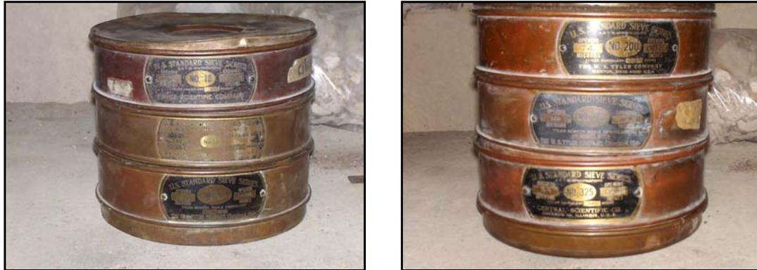
*Figura 9: Batería de tamices.*
