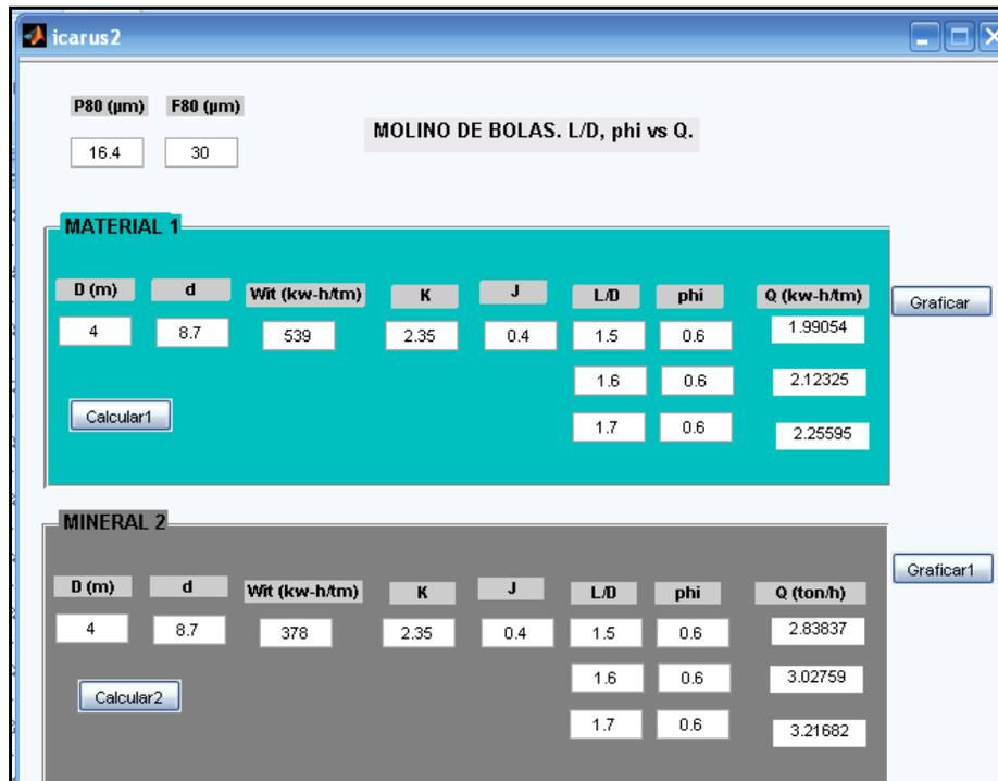
Figura 21: Análisis de L/D vs Q. Para un  $\phi=0,6$ .
