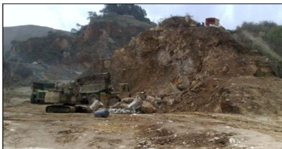
Foto 5.5. Caliza del sector intermedio con alta meteorización
