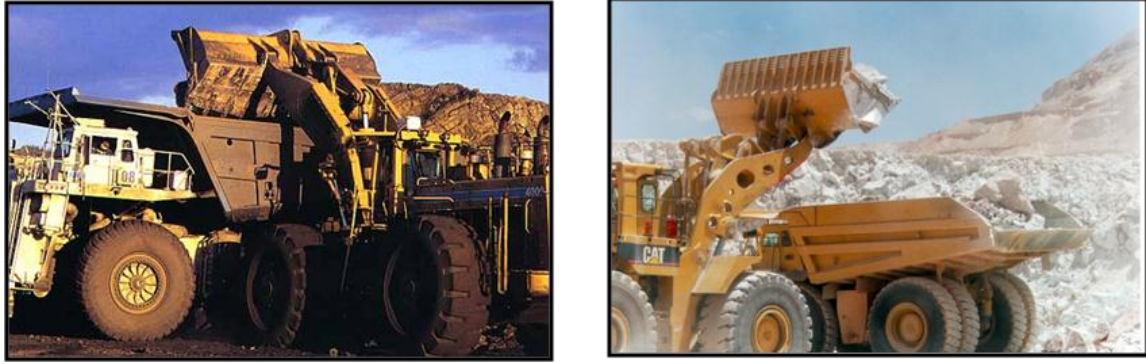
Figura 5.18. Equipos de carga (cargador frontal Caterpillar) y acarreo (camión Caterpillar). Tomado de Tópicos de Ingeniería en Minas a Rajo Abierto.
