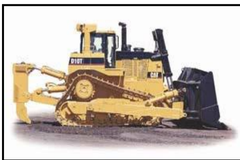
Figura 5.20. Tractor modelo D10T (izquierda). Motoniveladora (Cortesía de Caterpillar)
