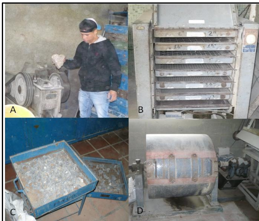
Figura 4.11. A) Trituración de la muestra; C) Tamizadora GilsonScreen, T469, modelo TM1; C) Muestra cernida; D) Máquina Los Ángeles, TiniosOlsen, N° 46452. Foto propia (2012)
