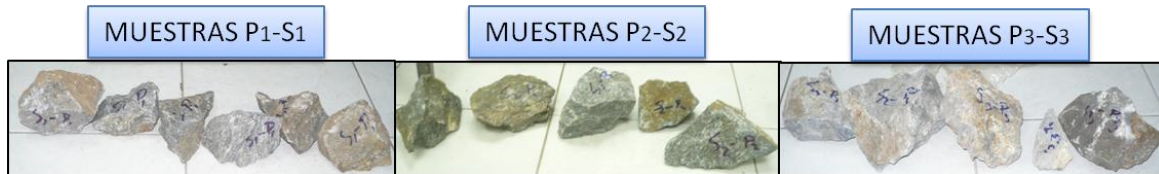
Figura 4.8. Muestras seleccionadas para la realización del ensayo de carga puntual. Fotos propias (2012)
