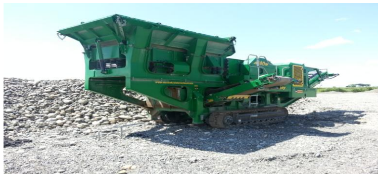
Figura N° 16. Unidad móvil modelo J40 compacta trituradora de mandíbula.
