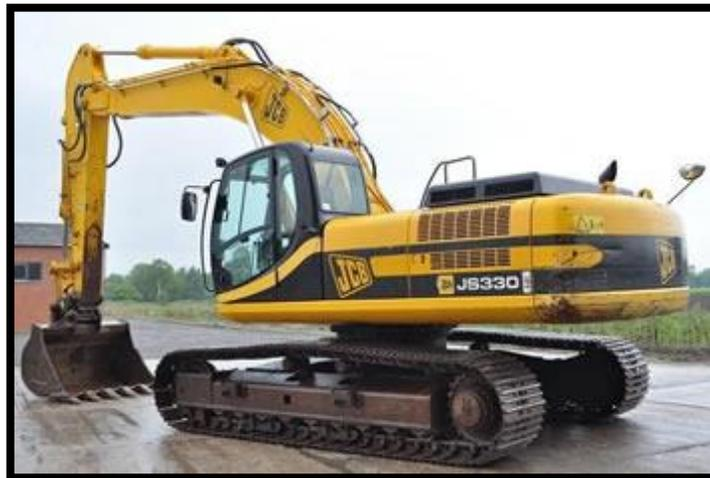
Figura 43. Equipo de arranque JCB JS 330.
