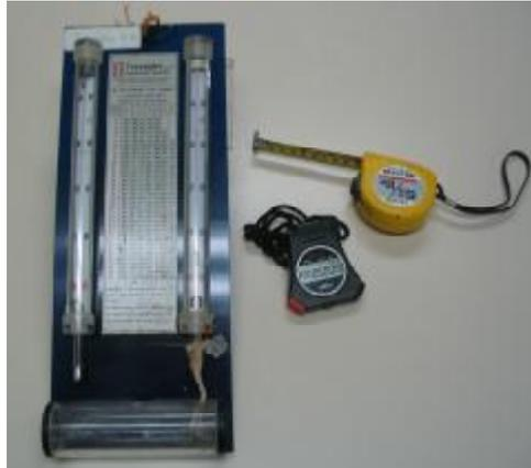
**Figura N°18:** Equipos usados para la medición de agua evaporada.
