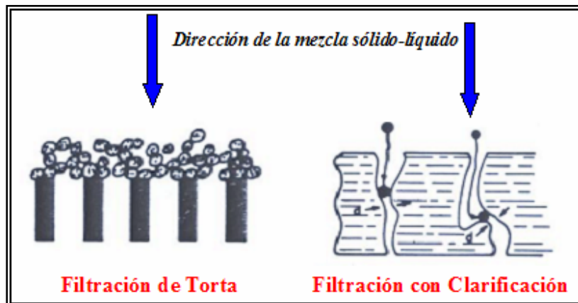
Fig. N° 11: Mecanismos de filtración.
