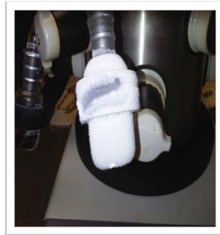
Figura 17.- Vial insertado en el liofilizador.
