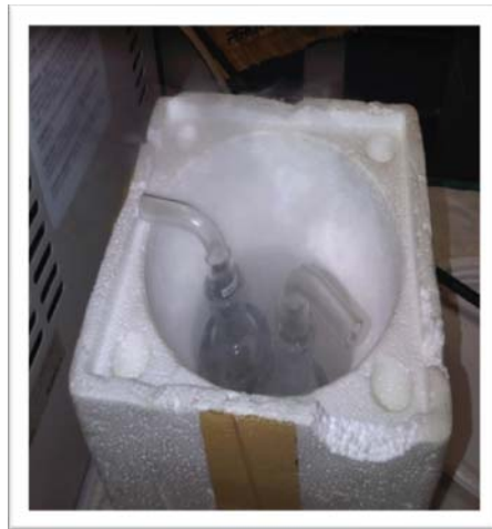
Figura 16.- Vial enfriado con nitrógeno líquido.
