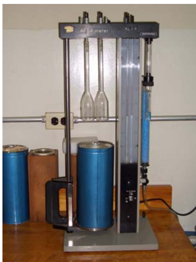
Figura 3.6 Equipo utilizado para la determinación del área
