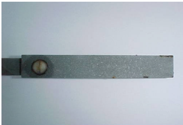
Figura N° 55. Vista del cupón de acero al carbono 1010 ubicado en el monitor de depósitos al final de la prueba con L-F5 (40 ppm diarios).
