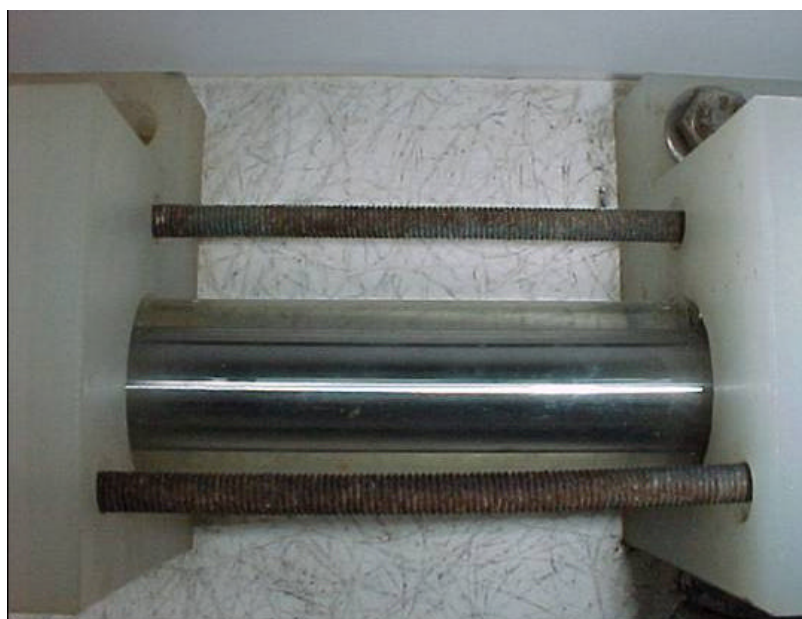
Figura N° 47. Vista del lado derecho del tubo de acero al carbono 1010 ubicado en el monitor de depósitos al final de la prueba con L-F5 (50 ppm diarios).
