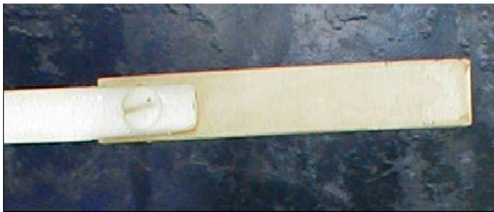
Figura N° 64. Vista frontal del cupón de admiralty brass ubicado en la cuponera, al final de la evaluación con los productos L-F6, L-F7 y L-F8 (120 ppm, 100 ppm y 600 ppm diarios).
