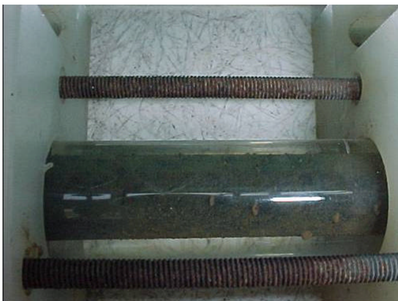
Figura N° 43. Vista del lado izquierdo del Tubo de Acero del Monitor de Depósitos al final de la prueba con L-216 M2 (40 ppm diarios).
