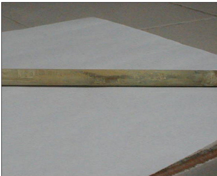
Figura N° 62. Vista frontal del tubo de acero al carbono 1010 al final de la evaluación con L-270 y L-F5 (100 ppm y 50 ppm diarios).
