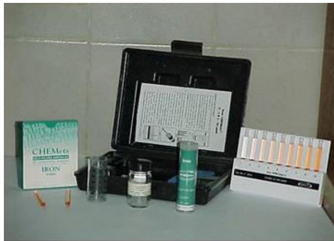
Figura N° 38. Ejemplo d reactivos y comparador para el análisis de agua (kit de Hierro).
