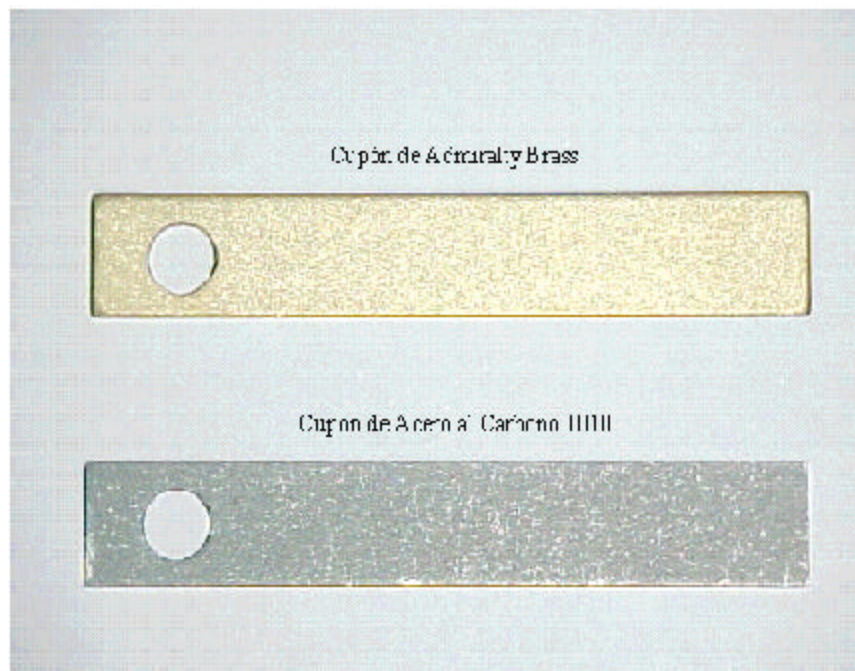
Figura N° 23. Cupones de corrosión.
