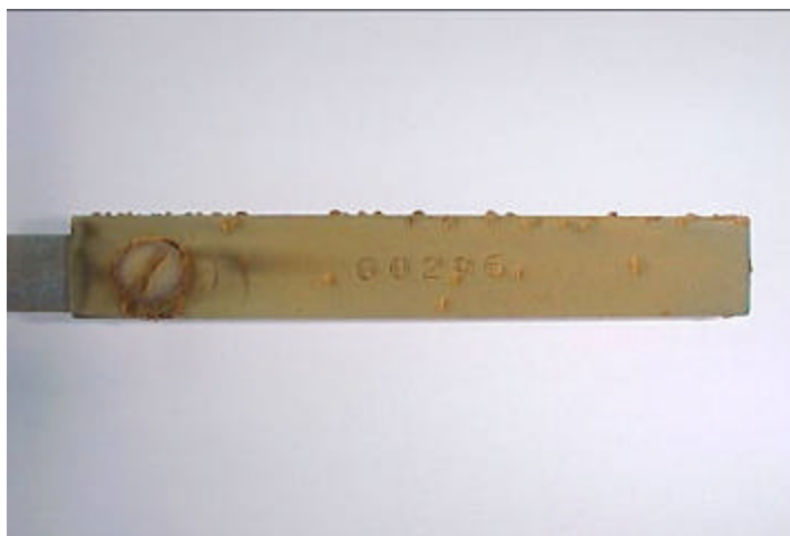
Figura N° 59. Vista del cupón de acero al carbono 1010 ubicado en el monitor de depósitos al final de la prueba con L-F5 y L-253 P (40 ppm y 10 ppm diarios).
