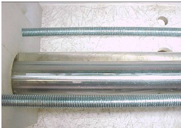
Figura N° 51. Vista del lado izquierdo del Tubo de Acero del Monitor de Depósitos al final de la prueba con L-F5 (40 ppm diarios).
