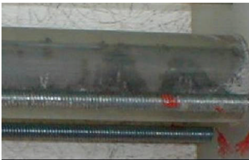
Figura N° 63. Aspecto del tubo de acero al carbono 1010 ubicado en el monitor de depósitos, al final de la prueba con los productos L-F6, L-F7 y L-F8 (120 ppm, 100 ppm y 600 ppm diarios).
