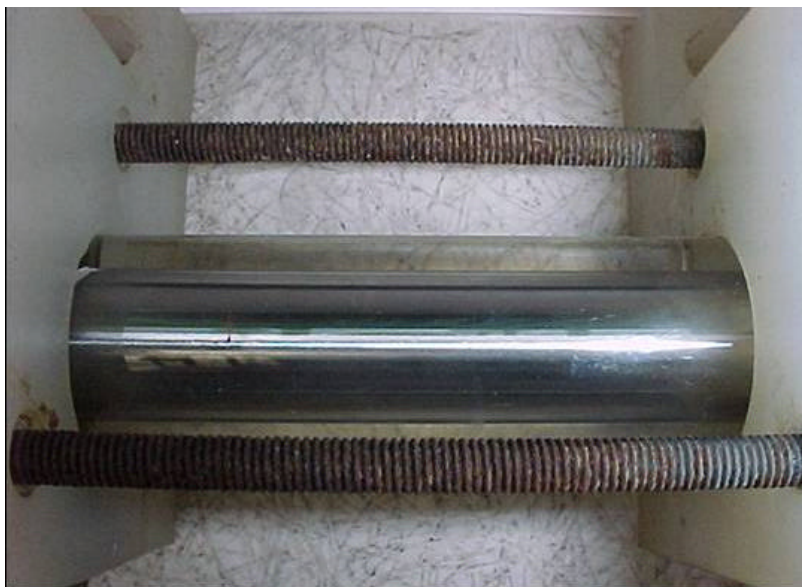
Figura N° 46. Vista del lado izquierdo del tubo de acero al carbono 1010 ubicado en el monitor de depósitos al final de la prueba con L-F5 (50 ppm diarios).
