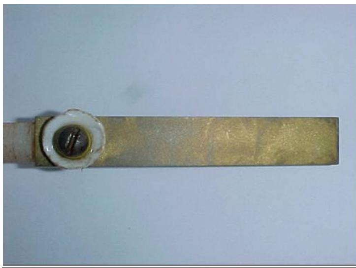
Figura N° 48. Vista del cupón de admiralty brass ubicado en la cuponera al final de la prueba con L-F5 (50 ppm diarios).
