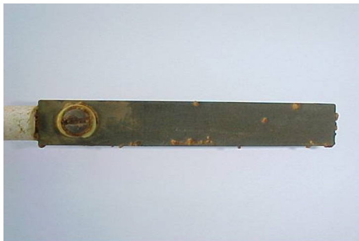
Figura N° 58. Vista del cupón de acero al carbono 1010 ubicado en la cuponera al final de la prueba con L-F5 y L-253 P (40 ppm y 10 ppm diarios).
