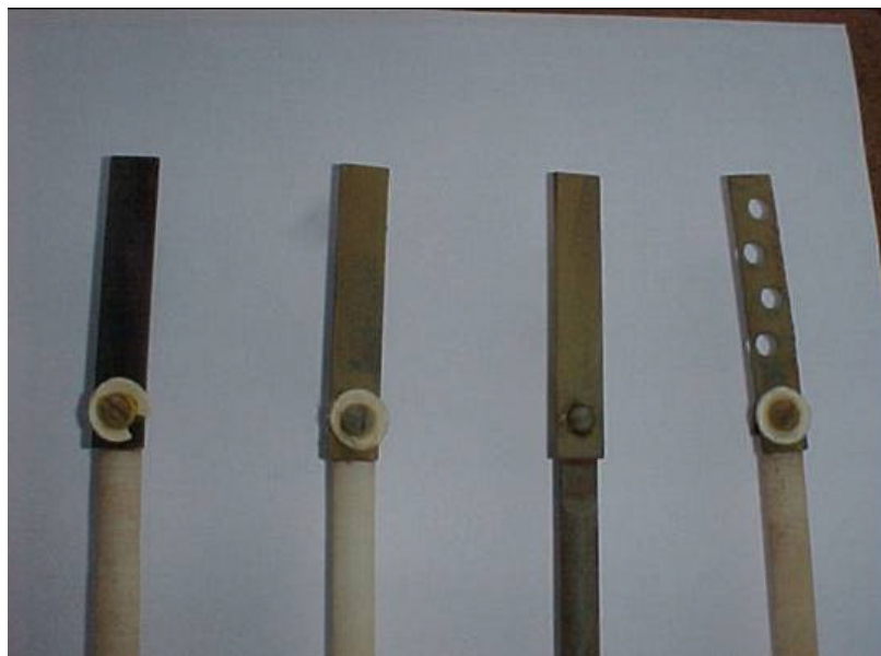
Figura N° 45. Vista de los cupones de admiralty brass y acero al carbono 1010 (de izquierda a derecha) al final de la prueba con L-216 M2 (40 ppm diarios).
