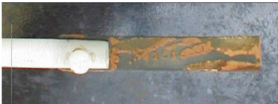
Figura N° 65. Vista frontal del cupón de acero al carbono 1010 ubicado en la cuponera, al final de la evaluación con los productos L-F6, L-F7 y L-F8 (120 ppm, 100 ppm y 600 ppm diarios).
