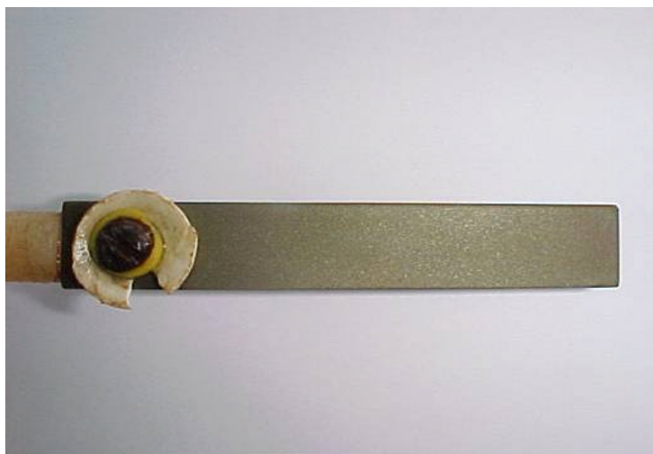
Figura N° 53. Vista del cupón de admiralty brass ubicado en la cuponera al final de la prueba con L-F5 (40 ppm diarios).
