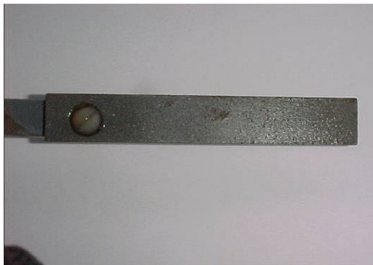
Figura N° 50. Vista del cupón de acero al carbono 1010 ubicado en el monitor de depósitos al final de la prueba con L-F5 (50 ppm diarios).
