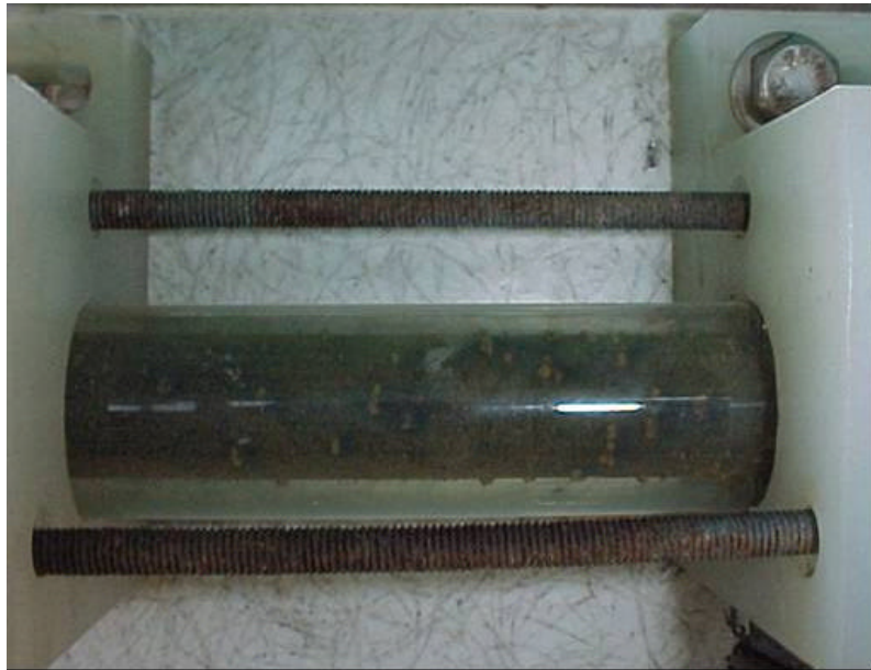
Figura N° 44. Vista del lado derecho del Tubo de Acero del Monitor de Depósitos al final de la prueba con L-216 M2 (40 ppm diarios).
