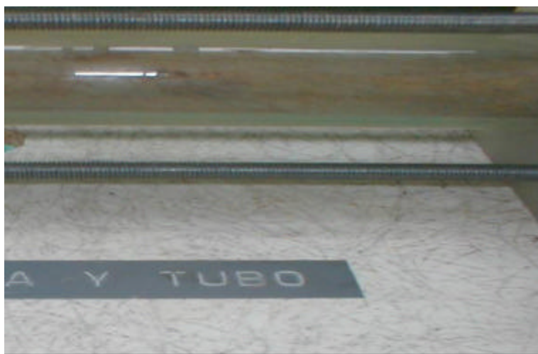
Figura N° 61. Vista de cerca del tubo de acero al carbono 1010 ubicado en el monitor de depósitos, al final de la evaluación con L-270 y L-F5 (100 ppm y 50 ppm diarios).
