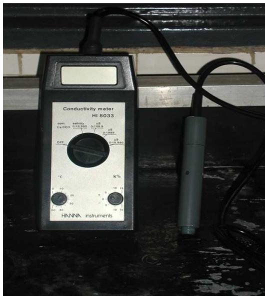
**Figura 19. Conductímetro del Laboratorio.**
