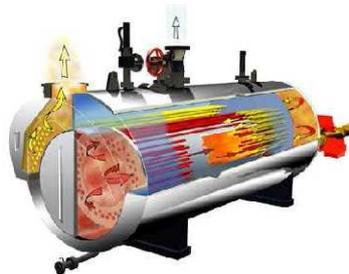
**Figura 1. Esquema de una caldera tipo pirotubular**
