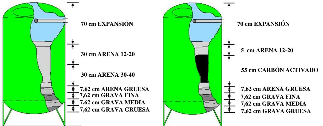
Figura N° 26. Distribución del lecho filtrante en los filtros de arena y carbón
