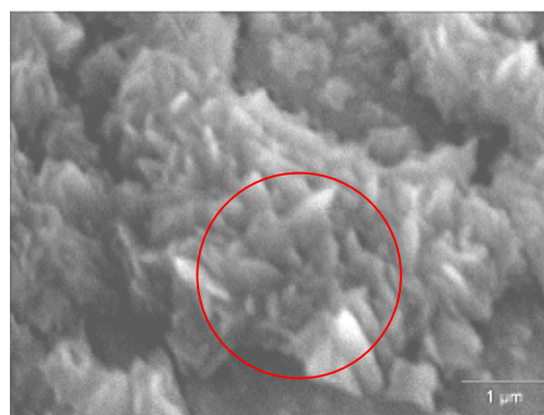
Figura N° 36. Lámina de FeCrAlloy con tratamiento térmico 20000X.
