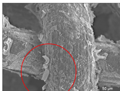
Figura N° 40. Malla de acero recubiertas con óxidos tipo perovskita
