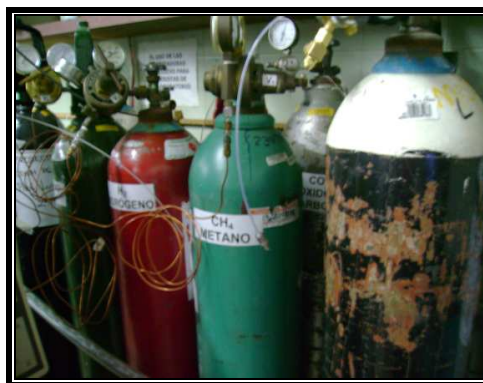
Figura N° 25. Banco de cilindros de Argón, metano, oxígeno y dióxido de carbono.
