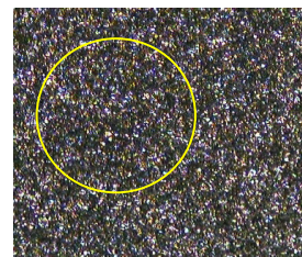
Figura N° 34. Lámina de FeCrAlloy con tratamiento ácido
