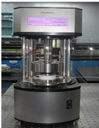
**Figura 12.** Tensiómetro Superficial de Placa y Anillo Dataphysics
