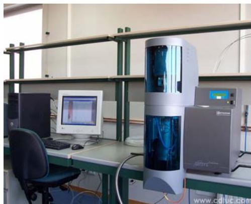
**Figura 16.** Equipo de TGA, Setaram modelo SETSYS 16
