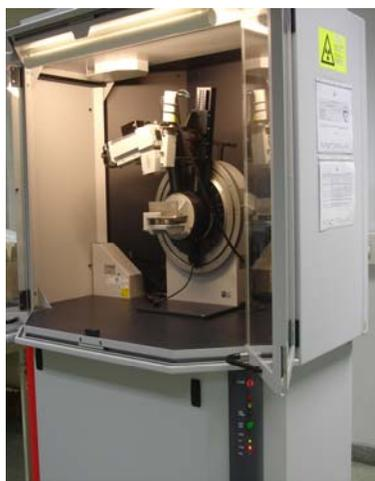
**Figura 19.** Difractómetro de Rayos X, modelo Phillips PW3710 Based
