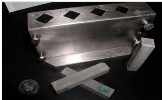
**Figura 21.** Celdas de moldeado de la mezcla agua-polvo calcinado.
