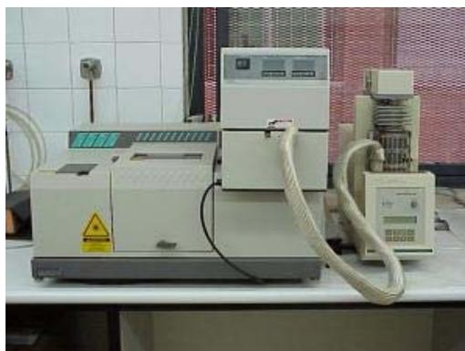
**Figura 17.** Espectrofotómetro Nicolet modelo Magna IR 760
