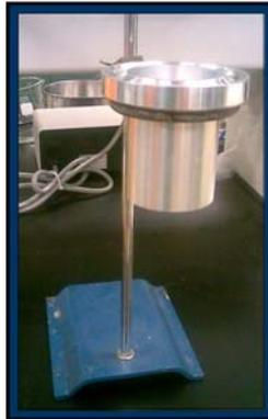
Figura III.2: Copa Ford # 4 utilizada para la medición de la viscosidad de las muestras (Elaboración Propia).
