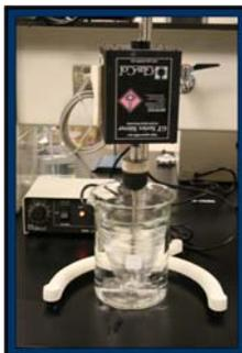
Figura III.1: Montaje del agitador para la preparación de las muestras (Elaboración Propia).
