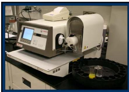
Figura III.3: Densitómetro AntonParr utilizado para la medición de la densidad de las muestras (Elaboración Propia).
