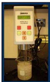
Figura III.4: Montaje para las mediciones de las viscosidades usando un viscosímetro de Brookfield RV. (Elaboración Propia).
