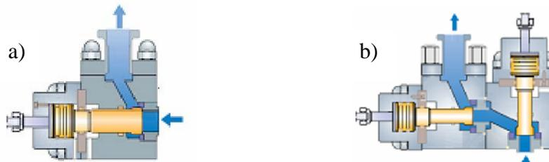
Figuras II.9: Homogenizadores de una (a) y dos etapas (b) (Tetra Pak, 2001).
