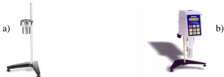
Figura II.2: (a) Copa de viscosidad acoplada a un soporte universal. (b) Viscosímetro rotatorio de Brookfield.
