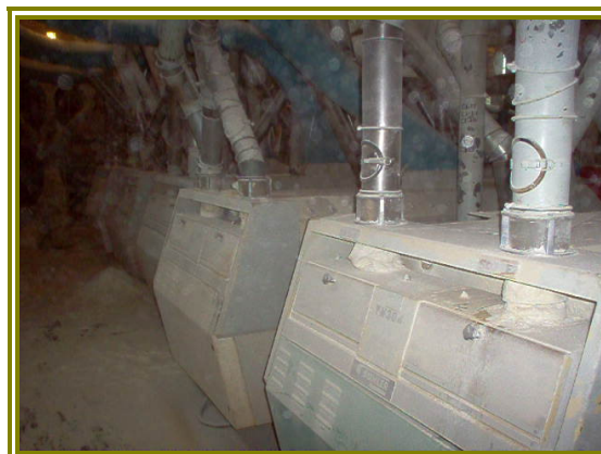
Figura 2.7. Sasores empleados para separar impurezas (SAS01-A/M) (Elaboración Propia)
