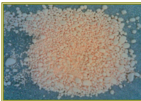
Figura 4.3. Granulometría inadecuada de ADA. (Elaboración Propia)
